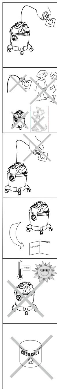
2. Кабель электропитания пылесоса оснащен заземляющей жилой для предотвращения поражения электрическим током. Для безопасности работы цепь электропитания рекомендуем оснастить устройством защитного отключения (УЗО). Не мочить штепсель сетевого шнура.
