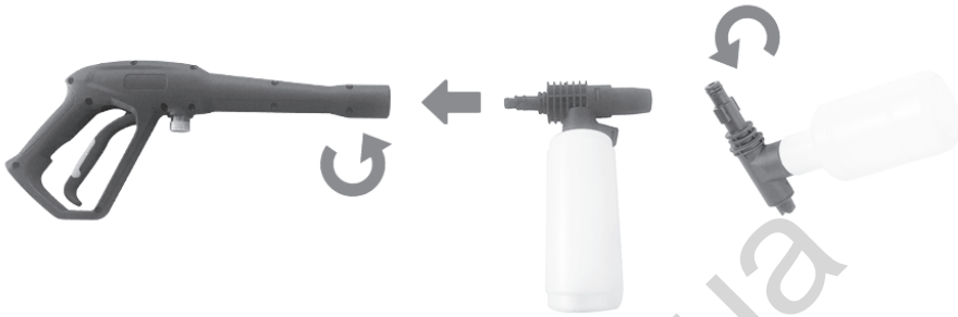
Рисунок 6. Схема встановлення пінної насадки.
