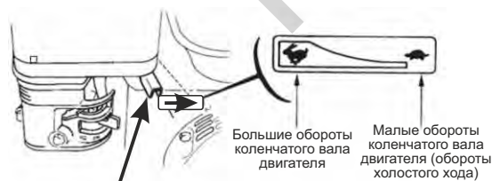
Рычаг управления дроссельной заслонкой
