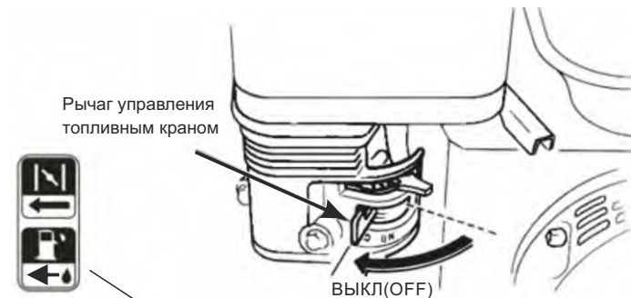
Символ, означающий «Выключить топливный кран» (стрелкой указано направление перемещения рычага)
