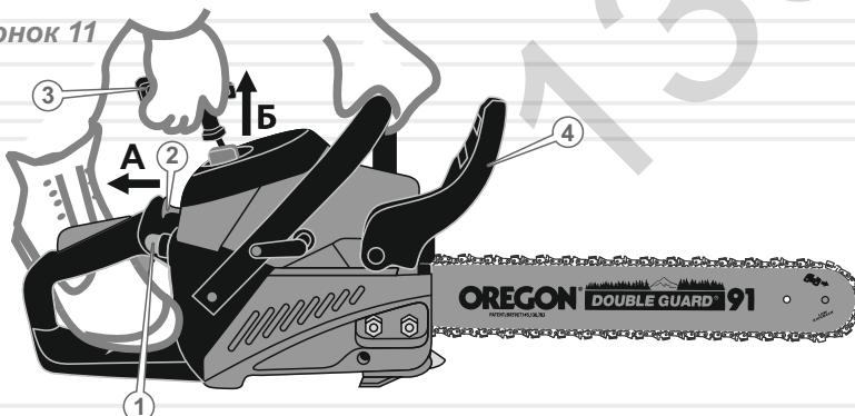
8. Закачайте паливо в карбюратор, використовуючи ручний паливний насос "праймер". Для цього натисніть 4–6 разів на ковпачок «праймера» (1), поки в ньому не з'явиться паливо (див. малюнок 11).
