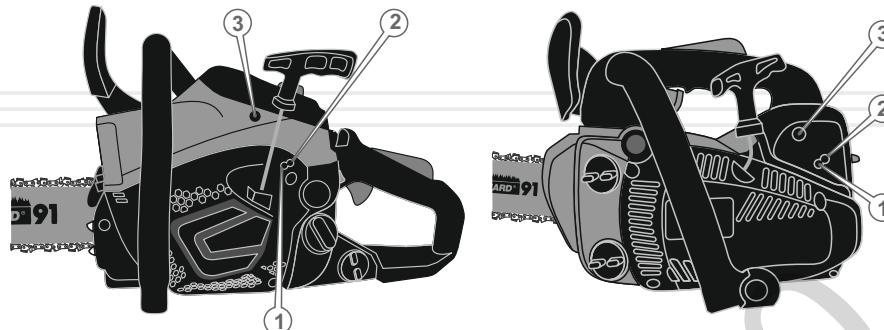
1. Регулювальний гвинт «L» – подача палива.
