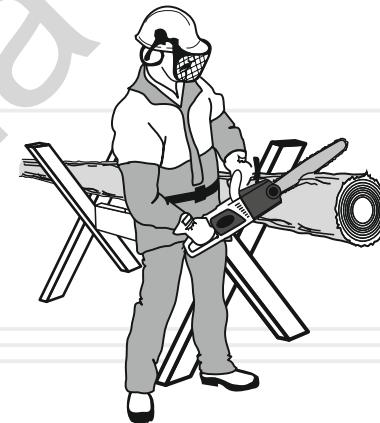
При розпилюванні колод краще всього використовувати козли як упор. Переконайтесь, що під час піляння, колода надійно закріплена (див. малюнок 17).
