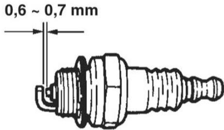
Очистіть електроди за допомогою щітки та відрегулюйте іскровий зазор до 0,65 мм.
