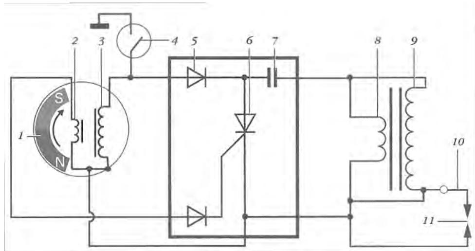
Схема запалювання, що використовує розряд конденсатора (CDI): 1 - ротор з магнітами; 2 - обмотка датчика; 3 - обмотка заряжаючої катушки; 4 - кнопка «стоп»; 5 - діод; 6 - тиристор; 7 - конденсатор; 8 - первинна обмотка катушки запалювання; 9 - вторинна обмотка катушки запалювання; 10 - високовольтний провід; 11 - свічка запалювання.
