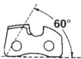
(60°) Кут ріжучої кромки верхньої пластини
