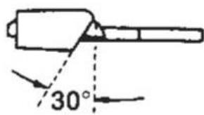
(30°) Кут обробки напильником
