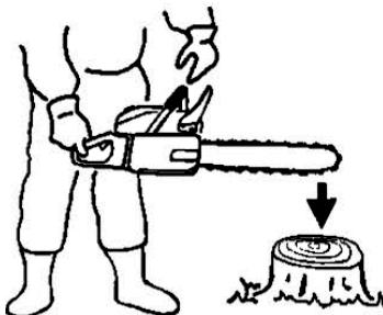
Якщо ви працюєте пилою при ввімкненому гальмі це приведе до перегріву пили та виходу з ладу.
