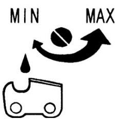
При повороті шток викруткою в напрямок стрілки вказує на положення "MAX" на ланцюг буде подаватися більша кількості масла; при його повороті в напрямку до положення "MIN", буде подаватися менше кількості масла. **Місце знаходження** : Дно силового вузла.
