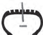
Неправильне встановлення джгута
