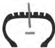
Неправильне встановлення джгута
