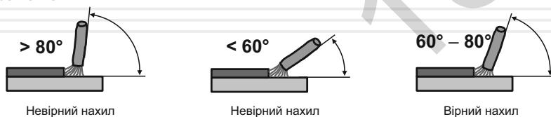
*Довжина електрода в процесі зварювання зменшується. Коли довжина електрода досягає 15–20 мм, припиніть зварювання і замініть електрод, натиснувши ручку електродотримача.*
