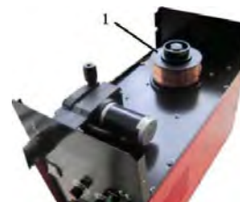
Рис. 8: Установка катушки с проволокой
