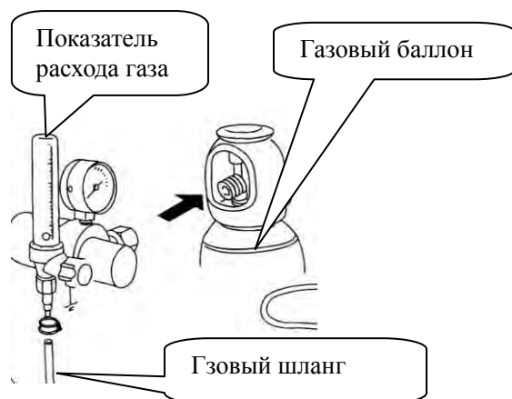
Рис. 5 Подключите шланг газ и газовый баллон
