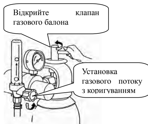
Мал.6: Відкрийте клапан газу і встановіть газовий потік
