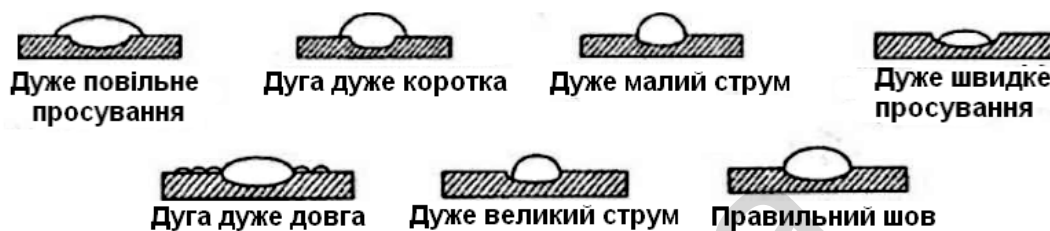
Рис. 11: Настройка дуги
