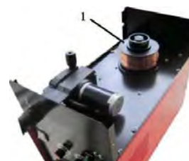
Рис. 8: Установка катушки с проволокой
