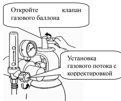
Рис.6 Откройте клапан газа и установите газовый поток
