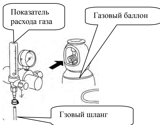
Рис. 5 Подключите шланг газ и газовый баллон
