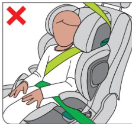
**! ISPĖJIMAS!** Istrižinis diržas turi eiti pro kedutės nugaras atramą ir niekada neturi eiti priekyje viršutinio diržo jūsų automobiliuje. If it is not possible to adjust the seat in this way, e.g. by pushing the car seat forward or using it on another seat, this car seat is not suitable for your vehicle. Esant abejonėms, susisiekite su autokėdutės gamintoju.
