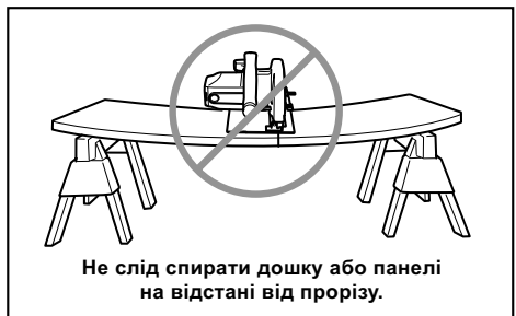
Для того, щоб запобігти віддачі, слід підпирати дошку або панель біля прорізу.
