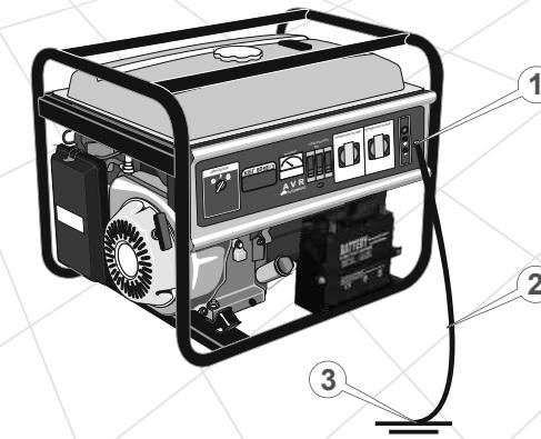
Заземлення запобігає можливості електрошоку. Щоб заземлити виріб використовуйте дріт заземлення (2) і заземлювач (3) (у комплект постачання електростанції не входить) (див. мал. 8).
