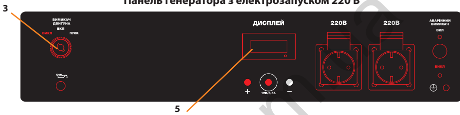
Панель генератора з електрозапуском 220 В та ATS
