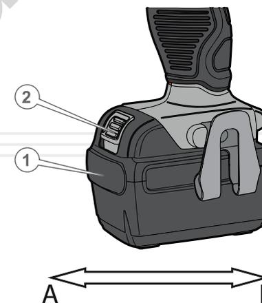
Перед встановленням або зняттям акумуляторної батареї завжди вимикайте ударного гайковерта і встановлюйте кнопку перемикача напрямку обертання шпинделя в центральне положення (режим блокування клавіші «Увімкнення/Вимкнення»).
