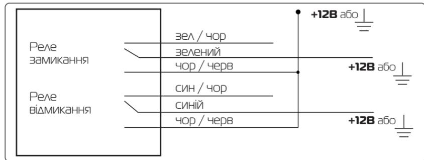
Схема підключення до двопровідним приводам системи замикання
