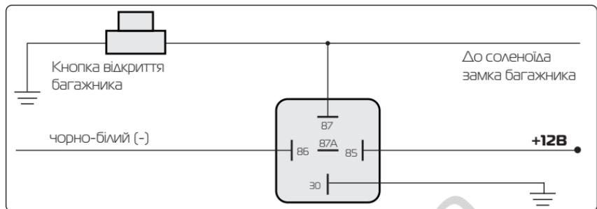
Схема підключення до соленоїда замку багажника з позитивною полярністю
