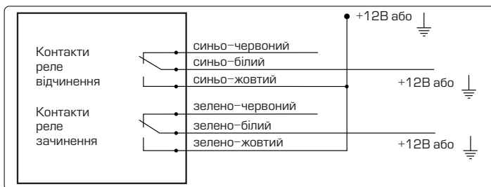
Схема під'єднання до системи з позитивним чи негативним управлінням
