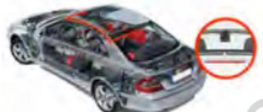
Після монтажу задньої камери необхідно підключити червоний провід кабелю камери до ланцюга живлення (+12 В) ліхтарів заднього ходу
