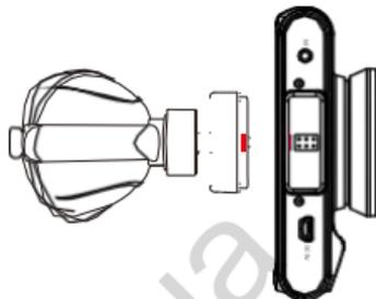
Основа тримача з другого боку має **1** паз, що з'єднується з **1** затискачем на корпусі камери
