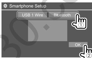
**[USB 1 Wire]** Виберіть це, коли пристрій підключено через вхідний роз'єм USB (шляхом підключення кабелю до задньої панелі).
