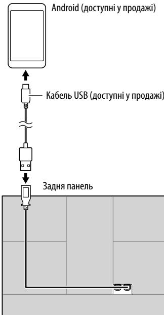
При підключенні до Android-пристрою відображається "HAND MODE". Ви можете керувати Android-пристроєм, використовуючи додаток для відтворення медіа, встановлений на Android-пристрій.
