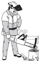
При прикосновении пильного полотна к пню должен сработать тормоз.
