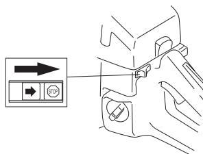
двигатель останавливается, когда контакт остановки будет передвинут в положение остановки.
