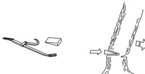
Мы рекомендуем пользоваться шиной пилы, длина которой бы превышала диаметр ствола, чтобы валиящий и направляющий срезы могли выполняться т.н. "одинарным срезом". См. указания в разделе Технические данные,
