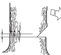
Вставьте зубчатый упор (если установлен) сзади надреза. Работайте на полном газу и вводите пильное полотно в ствол дерева постепенно, плавным движением. Следите за тем, чтобы дерево не начало перемещаться в направлении, противоположном предполагаемому направлению падения. Как
