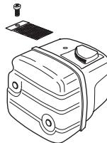
Глушитель служит для снижения уровня шума и отвода раскаленных выхлопных газов от рабочего. Выхлопные газы очень горячие и могут содержать искры, что может привести к пожару при прямом попадании на сухой и воспламеняющийся материал.
