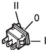
Переключатель отключен в положении "0", подает ток к подогреву ручки в положении "л", подает ток к подогреву карбюратора в положении "лл".
