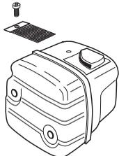
Глушитель служит для снижения уровня шума и отвода раскаленных выхлопных газов от рабочего. Выхлопные газы очень горячие и могут содержать искры, что может привести к
