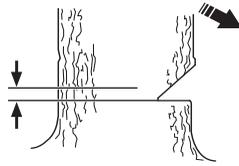
Вставьте зубчатый упор (если установлен) сзади надреза. Работайте на полном газу и вводите пильное полотно в ствол дерева постепенно, плавным движением. Следите за тем, чтобы дерево не начало перемещаться в направлении, противоположном падению. Как только пропил станет достаточно глубоким, загоните в него клин или вагу.
