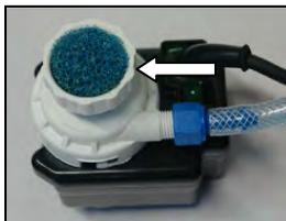
Для этого снимите прикрепленную сетчатую крышку, вытащите губку и промойте ее под чистой водой.
