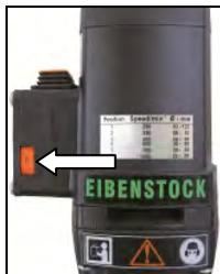
Станок имеет круглый регулятор для бесступенчатой регулировки оборотом между 250 и 1000 мин<sup>-1</sup>.
