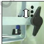
Установите правильные обороты для соответствующего диаметра коронки круглым регулятором и включите машину. Следуйте инструкциям производителя коронки. Нажмите кнопку включения устройства. Насос включается одновременно с машиной. Вы можете регулировать количество воды с помощью мини-шаровой крана на насосе. Не начинайте пока, пока из сверлильной коронки не потечет достаточное количество воды.
