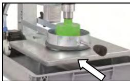
Для отверстий диаметром до 40 мм используйте накладную пластину. Для отверстий более 40 мм ее обязательно необходимо убрать.
