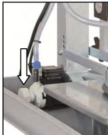
Циркуляция воды на **станке EFB 152 PX** обеспечивается насосом. Перед запуском машины заполните поддон для сбора воды до тех пор, пока впускное отверстие насоса не будет полностью закрыто водой. Только тогда гарантирована безупречная работа. Эксплуатируйте станок только с достаточной подачей воды, так как в сухом режиме будут повреждены уплотнители.
