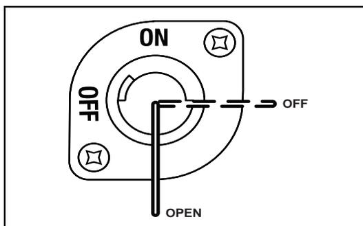
**(RU) Использование крана выключения подачи топлива (F)**
