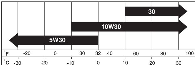
Меняйте масло через каждые 25 часов эксплуатации либо один раз в год, если снегоотбрасыватель используется менее 25 часов в год.
