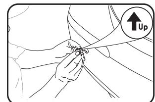
6. вставьте датчик в отверстие и вдавите внутрь
