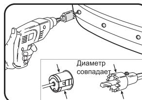
4. проверьте перед работой: диаметр датчика должен совпадать с размером фрезы
