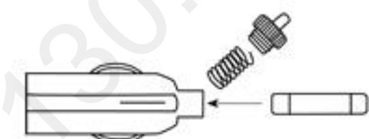
**Важно:** откручивать съемную часть адаптера необходимо медленно, так как он содержит пружину, которая при разборке может выскочить. Вставьте новый предохранитель и закрутите съемную часть. Со временем при использовании съемная часть может самопроизвольно откручиваться. Периодически проверяйте надежность соединения.
