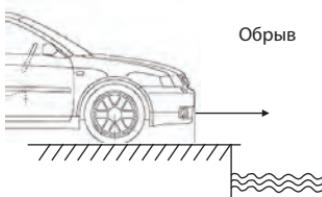
Если датчик загрязнен или поврежден, а также во время дождя или снега работа системы может быть некорректной.
