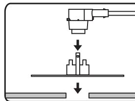
5. приклейте крепление датчика с внутренней стороны бампера, предварительно обезжирев поверхность. Вставьте датчик в крепление
