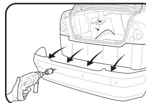
4. просверлите посадочные отверстия, демонтируйте бампер. Толщина бампера не должна превышать 4,5 мм
