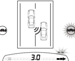
Предупредительный светодиод загорается при обнаружении помехи в слепой зоне, а звуковой сигнал прозвучит при включении поворотников в сторону помехи
