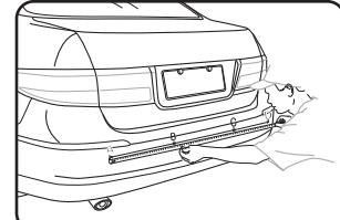
3. разделите отмеченную точками горизонтальную линию на три отрезка и отметьте средние точки
