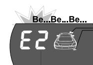
положение неисправного датчика
