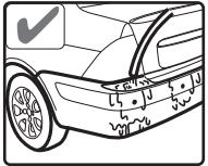
мойте датчики под низким давлением воды, после мойки, продуйте датчики сжатым воздухом, для удаления влаги
