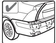
мойте датчики под низким давлением воды, после мойки, продуйте датчики сжатым воздухом, для удаления влаги
