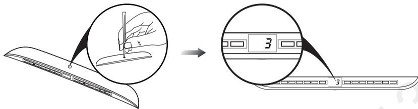
При установке LED-индикатора на обшивку крыши в задней части салона необходимо, чтобы цифровая индикация выводилась в зеркальном отображении.
