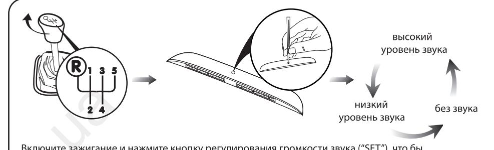
Включите зажигание и нажмите кнопку регулирования громкости звука ("SET"), что бы выбрать наиболее подходящий уровень звука или же выключить звук.
