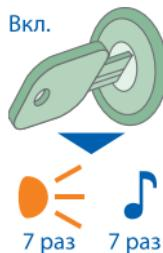
Выход из режима «Регистрация устройств» осуществляется выключением зажигания.
