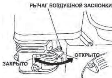
**Рычаг воздушной заслонки** служит для открытия и закрытия воздушной заслонки в карбюраторе. В положении «ЗАКРЫТО» топливно-воздушная смесь обогащается. Это позволяет запустить «холодный» двигатель. Положение «ОТКРЫТО» используется для работы двигателя после запуска, а также для повторного запуска «горячего» двигателя.
