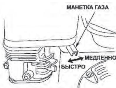
**Манетка газа** служит для регулирования скорости оборотов двигателя. В зависимости от положения манетки двигатель работает быстрее или медленнее. Мощность насоса регулируется манеткой газа. Увеличение скорости работы двигателя ведет к увеличению мощности насоса. Передвигая манетку в направлении позиции холостого хода можно уменьшить мощность насоса.
