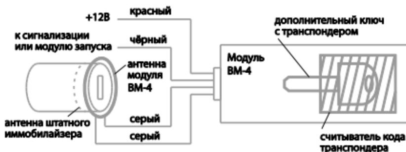
Закрепите внешнюю рамочную antennу на цилиндре замка зажигания и подключите её к разъёму на конце серых проводов.
