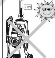
9. Во время летнего периода или при высокой температуре окружающей среды во избежание образования конденсата на электрической части мойки, преждевременного перегрева узлов из-за высокой температуры окружающей среды, расположите ее в проветриваемом помещении. Избегайте попадания прямых солнечных лучей на корпус и детали мойки.
