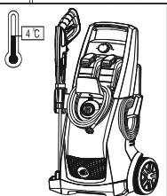
5. Запрещена эксплуатация мойки на улице в случае падения температуры окружающей среды ниже +4°C. В случае длительного простоя мойки, гидросистема может быть повреждена - может произойти разрыв гидравлической системы замерзшей водой или перекачиваемой жидкостью.
