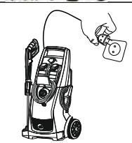
3. Мойка высокого давления должна иметь надежное заземление для предотвращения поражения электрическим током. Для безопасности мойку и цепь электропитания рекомендуем оснастить устройством защитного отключения (УЗО). Не мочить штепсель сетевого шнура.
