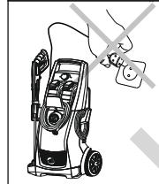
7. Следите, чтобы мойка неожиданно не включилась при монтаже или демонтаже, в этом случае и при длительном простоя мойки всегда держите сетевой тумблер выключенным, а элементы запорной арматуры на напорном трубопроводе - закрытыми.
