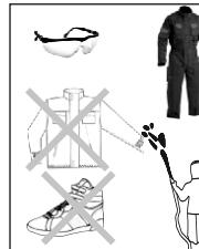
6. При работе с мойкой надевайте защитную одежду и защитные очки, так как перекачиваемая жидкость подается под высоким давлением и различные частицы (осколки) могут разлетаться с высокой скоростью.
