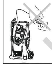
7. Слідкуйте, щоб мийка не сподівано не увімкнулась при монтажі або демонтажі, в цьому випадку і при тривалому простої мийки завжди тримайте мережевий тумблер вимкненим, а елементи запірної арматури на напірному трубопроводі - закритими.
