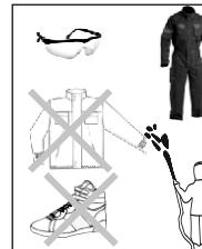
6. При роботі з мийкою надягайте захисний одяг і захисні окуляри, так як рідина, що перекачується може бути під високим тиском і різні частинки (уламки) можуть розлітатися з високою швидкістю. Не використовуйте мийку для очищення одягу або взуття, тим більше якщо вони знаходяться на людині.
