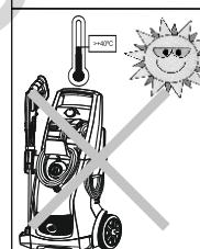
9. Під час літнього періоду або при високій температурі навколошнього середовища, щоб уникнути утворення конденсату на електричній частині мийки та передчасного перегріву вузлів через високу температуру навколошнього середовища, розташуйте мийку у вентильованому приміщенні.
