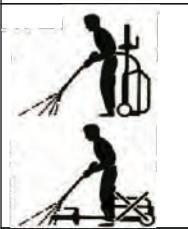
2. Під час роботи мийка високого тиску повинна бути встановлена вертикально.
