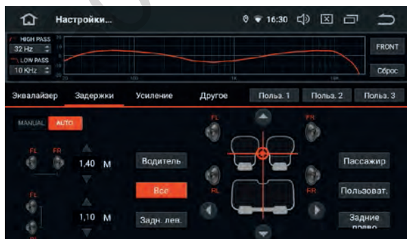
Автоматическая настройка временных задержек
