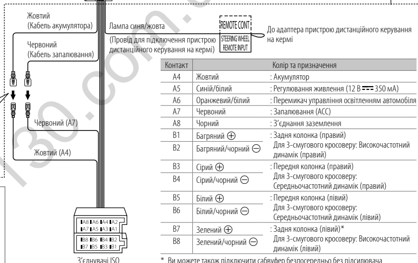
Стандартний варіант схеми підключення проводів
