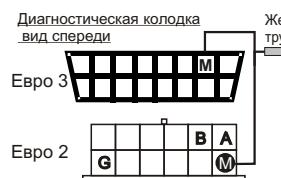
Противоположный конец этого провода - клемму "мама" вставьте в гнездо "2" колодки маршрутного компьютера а/м.
