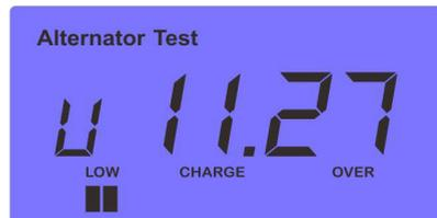
5. На ЖК экране отобразится относительная шкала уровня напряжения бортовой сети и его фактическое значение:
