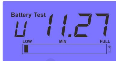
5. На ЖК экране отобразится относительная шкала уровня напряжения и его фактическое значение:
