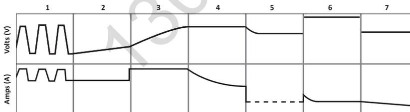
1. Десульфирование - На автоматическом этапе десульфирования происходит импульсная зарядка аккумулятора с целью разрушения кристаллов сульфата свинца, которые образуются в аккумуляторе. Такие кристаллы образуются когда аккумулятор полностью разряжен или оставлен без использования на долгое время.
