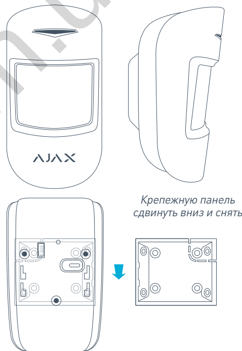
РИС. 1. Датчик движения MotionProtect и его крепежная панель
