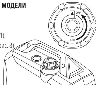
7. После остановки дайте генератору остыть и закройте вентиляционное отверстие на крышке топливного бака (положение OFF, рис. 6, для моделей KS 2000i S, KS 2100i S, KS 2000iG S - при остановке работы на бензине).
