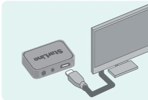
Для настройки и обновления программного обеспечения основного блока используйте приложение StarLine Мастер, подключив иммобилайзер к компьютеру по USB.
