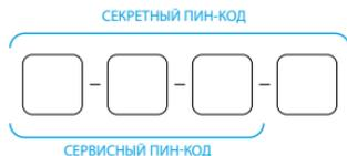
**Секретный ПИН-код** - заводское значение 1-1-1-1. Применяется для дополнительной авторизации при соединении иммобилайзера с мобильным приложением (Pandect BT) или для подтверждения изменённых параметров иммобилайзера через настройки приложения. «Секретный ПИН-код» можно изменить в настройках приложения.
