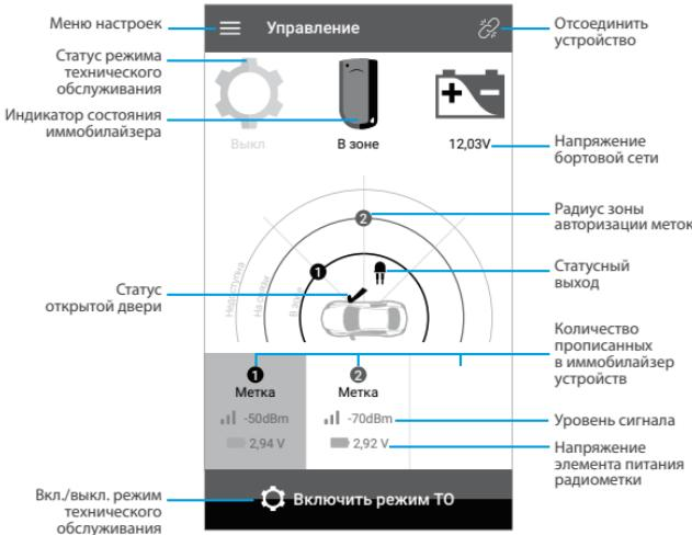
Управление режимом «ТО» может осуществляться тремя способами, при этом не имеет значение каким способом будет включен или выключен режим. Второй и третий способ может применяться для экстренного отключения радиометки иммобилайзера в случае утери, не исправности или разряженного элемента питания.
