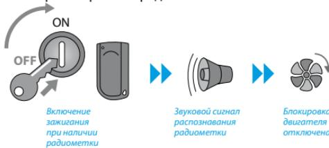
Если в момент включения зажигания радиометка нет в зоне действия радиообмена, блок иммобилайзера активирует противоугонную функцию (заблокирует работу двигателя). Блокировка двигателя может осуществляться в зависимости от настроек, при включенной или выключенной функции датчика движения.
