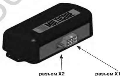
Рис. 7. Внешний вид контрольного блока
